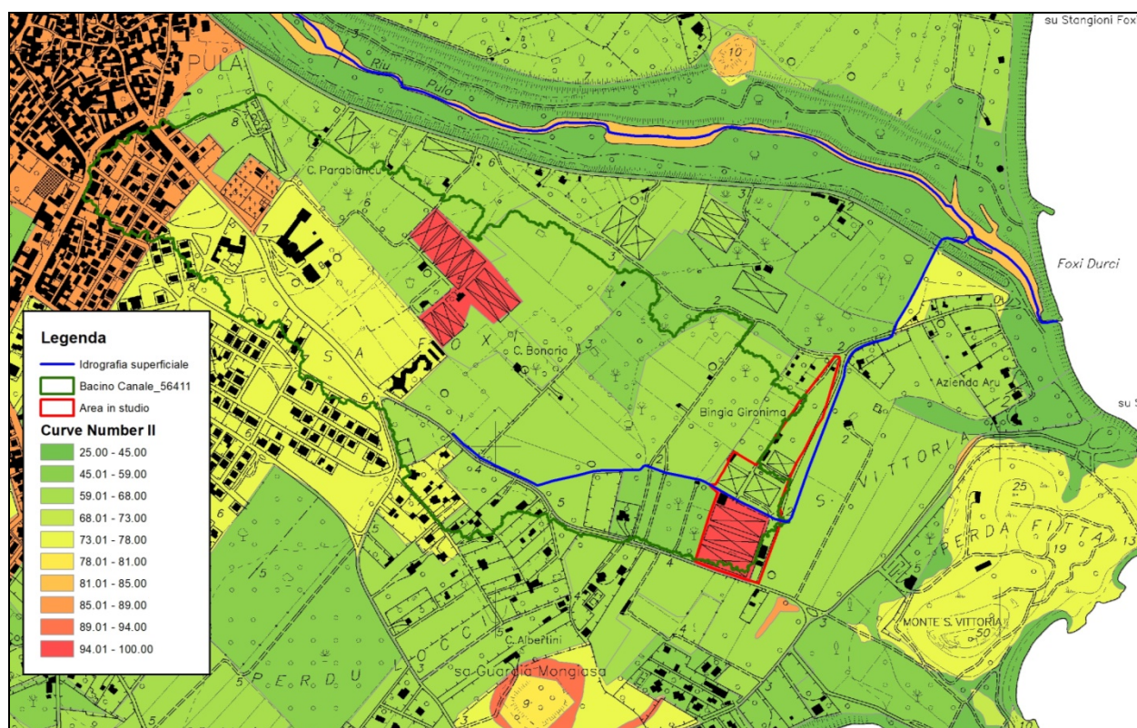
Figura 3.3 –Determinazione del Curve Number, per il bacino oggetto delle analisi idrologiche e idrauliche
